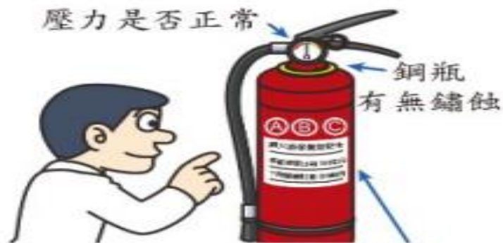
滅火器性能檢查
