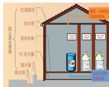
有害事業廢棄物貯存設施防漏及污染防治示意圖
