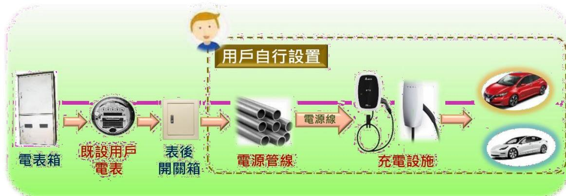
3. 按樓層專設一戶供電係由管委會按樓層專設一戶及整體規劃電纜架、導線槽或匯流排槽，日後車主只需由停車格鄰近電纜架、導線槽或匯流排槽拉設充電設施電源線，達到擴增方便之功效。
