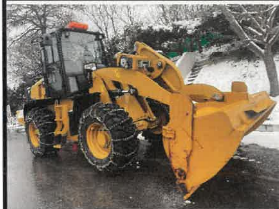
加雪鏈的鏟雪車，於路面坡度較大的路面進行鏟雪工作
